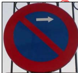
Señal R-308. Estacionamiento prohibido (Anexo I: Señales verticales de reglamentación: prohibición o restricción R-)
